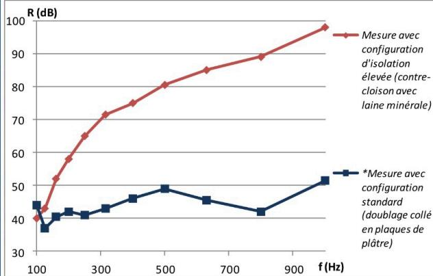
Les capacités d'absorption phonique des Blocs Coffrants Isolants ont été mesurées au CSTB
